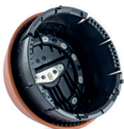
Remachado ultrasónico de las tapas de airbag
